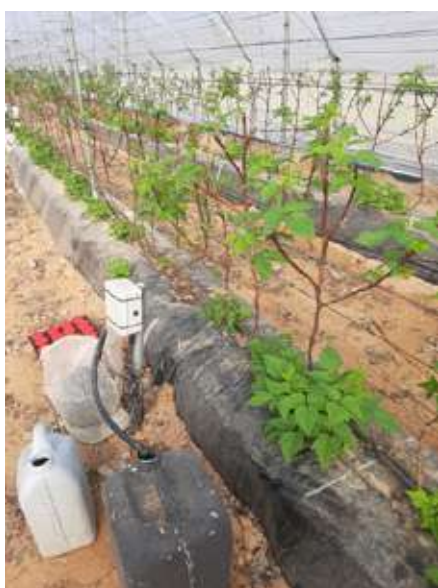
Foto 4. Recogida del agua de drenaje de los lisímetros para su posterior análisis químico.
