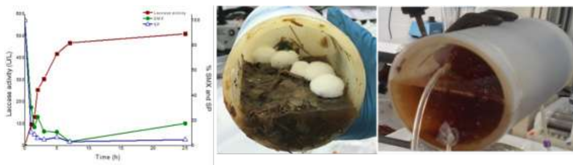
Figura 3. Evolución de la actividad enzimática lacasa en el filtro y de las concentraciones de sulfametoxazol y sulfapiridina en el biogeofiltro de escala de laboratorio.
