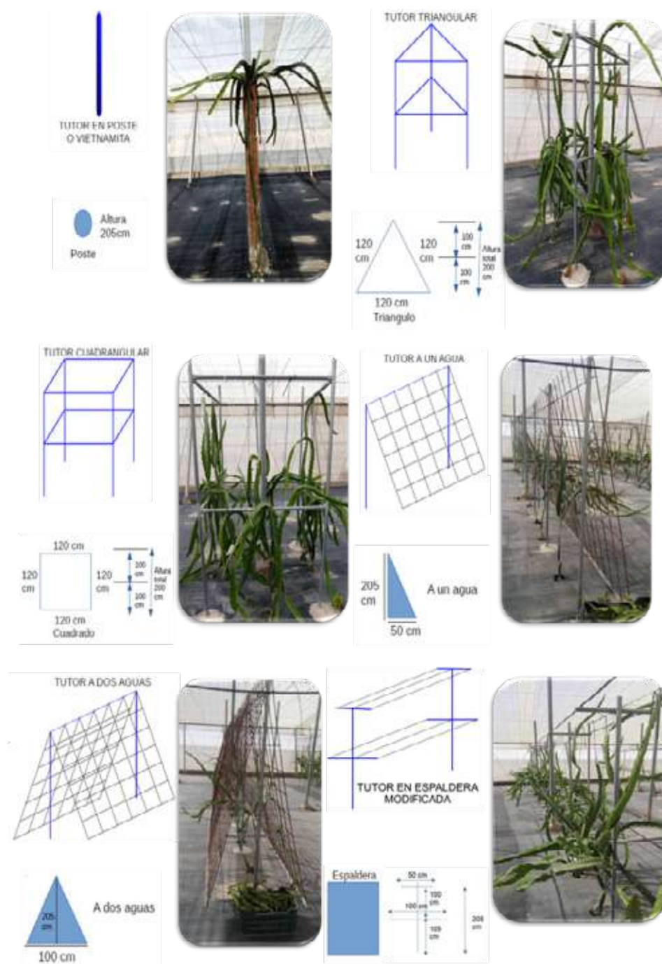
Figura 1. Descripción gráfica y dimensiones de los seis sistemas de entutorado evaluados.
