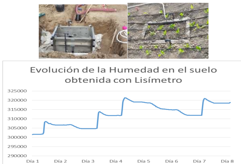
Figura 4. Lisímetro de pesada y algunos resultados obtenidos.
