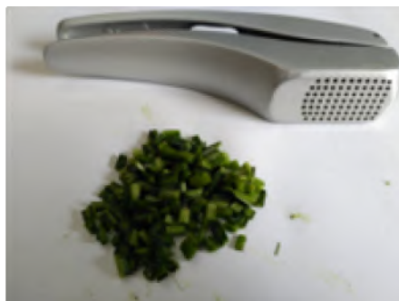
Foto 1. Prensa manual utilizada para la extracción de la savia de los pecíolos del cultivo de pimiento.
