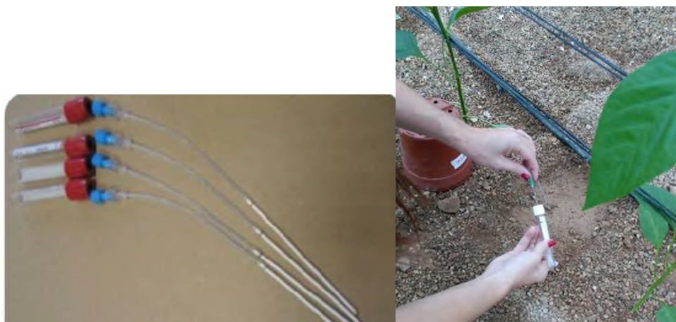
Foto 1. Sonda de succión Rhizom SMS Rhizosphere® (izqda.). Extracción de la solución del suelo en tubo de vacío (drcha.).
