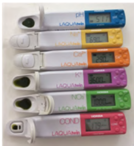
Foto 2. Equipos rápidos de análisis Laquatwin utilizados para medir la concentración de pH, C.E., y nutrientes en savia.
